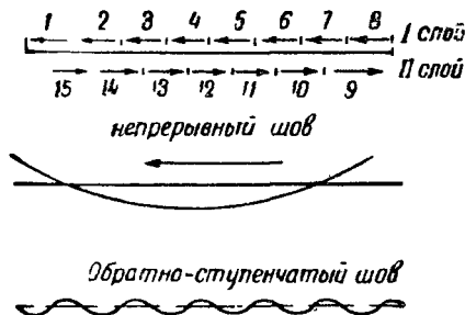
Рис. 60. Обратно-ступенчатый порядок наложения швов
